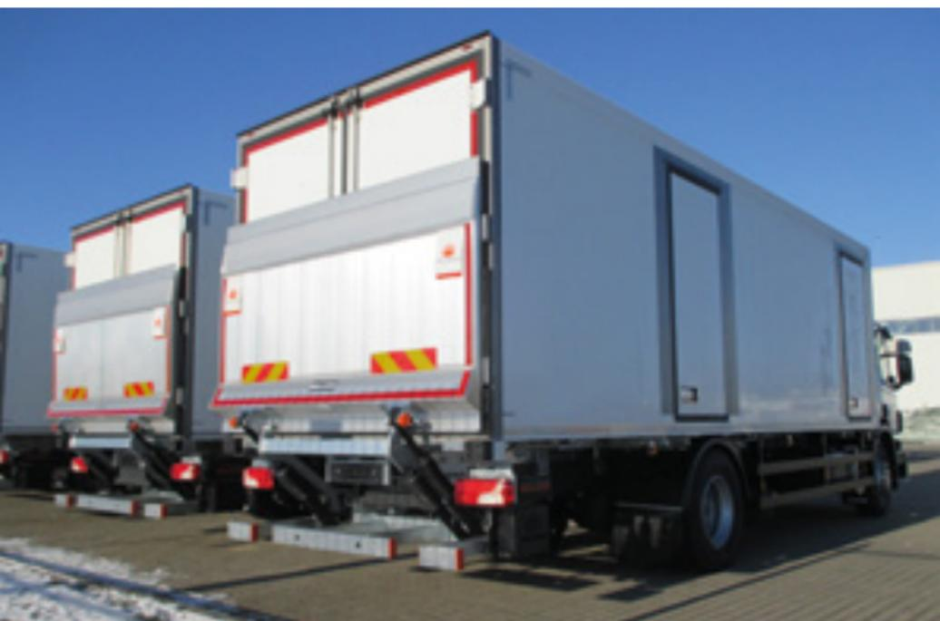
La DH-LM.20 è una **sponda di media capacità estremamente versatile**, adatta ad autocarri al sopra dei 7.5T PTT, rimorchi e semirimorchi.
